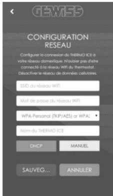
Si le routeur domestique travaille en DHCP, la configuration est terminée ; inversement, il faudra sélectionner la modalité **MANUEL** et compléter les paramètres de réseau (adresse IP, masque de sous-réseau, Gateway prédefinie, DNS1, DNS2).
