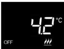
El **funcionamiento antihielo** está activo solo en calefacción, con la instalación de termorregulación apagada (OFF).
