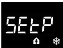
**Configuración del punto de ajuste Comfort (si el control es “HVAC”)**
