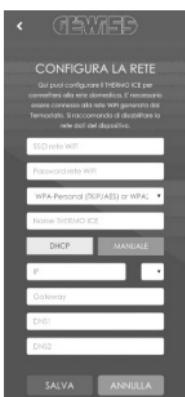
Una volta terminata la configurazione, premere il pulsante **SALVA** per inviare i dati al THERMO ICE. Sul dispositivo mobile, il corretto salvataggio dei dati da parte del termostato viene segnalato attraverso apposita notifica video; in caso contrario, viene visualizzato un popup di errore per notificare eventuali problemi riscontrati.
