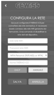
Inserire i parametri della rete domestica (SSID rete WiFi, Password rete WiFi, Crittografia rete WiFi) ed il nome che si vuole assegnare al termostato (Nome THERMO ICE); quest'ultimo viene memorizzato anche nel server remoto e permetterà di identificare il singolo termostato durante la fase di discovery ed assegnazione termostato all'utente.
