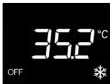
El **funcionamiento de protección de altas temperaturas** está activo solo en refrigeración, con la instalación de termorregulación apagada (OFF).
