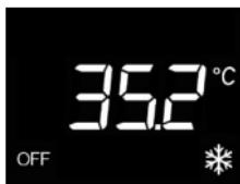
Il **funzionamento protezione alte temperature** è attivo solo in raffrescamento, a impianto di termoregolazione spento (OFF).
