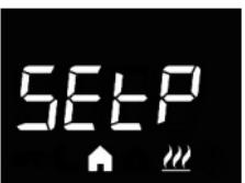
**Configuración del punto de ajuste Precomfort (si el control es "HVAC")**
