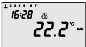
Nel **funzionamento manuale** il cronotermostato utilizza permanentemente un set point di temperatura, che può essere liberamente impostato.
