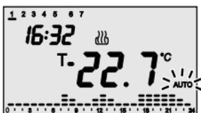
Die Aktivierung der Übersteuerung wird auf dem Display mit dem Blinken des Symbols AUTO signalisiert.
