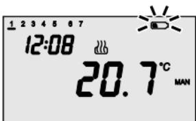
Quando le batterie sono in fase di esaurimento, sul display inizia a lampeggiare il simbolo .
