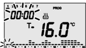
Sur l'afficheur apparaissent le symbole **T-**, **T=** ou **T≡** et la valeur qui correspondent au set-point sélectionné. Ce set-point reste appliqué au profil horaire jusqu'à la première variation présente dans le programme courant.
