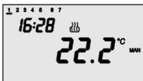
Im **manuellen Betrieb** verwendet der Chronothermostat permanent einen Temperatur-Bezugswert, der frei eingestellt werden kann.
