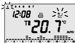
Ist die Funktion aktiv wird der Tag angezeigt auf dem das Profil des Wochentages kopiert wurde: Auf dem Display blinkt der übereinstimmende Balken auf.
