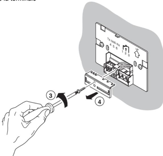
Conectare la centrala termică/aparatură de aer condiționat și la comunicator (3 cabluri)
