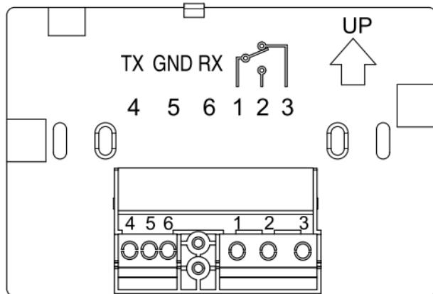
Connexion par le système de contrôle à distance (ligne sérielle)
