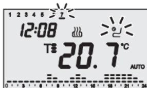
Pentru a activa funcția, apăsați tasta , pe afișaj clipesc simbolul și liniuța zilei de sărbătoare. Cu ajutorul tastelor , selectați ziua din săptămână pentru care dorîți să copiați profilul zilei de sărbătoare; apăsați tasta sau așteptați 30 secunde pentru a confirma setarea efectuată.
