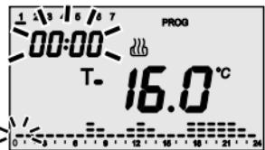
Auf dem Display erscheint das Symbol **T-**, **T=** oder **T#** und der Wert in Bezug auf den gewählten Bezugswert. Der Bezugswert wird mit dem Uhrzeitprofil angewendet bis zur ersten Änderung die im laufenden Programm anwesend ist.
