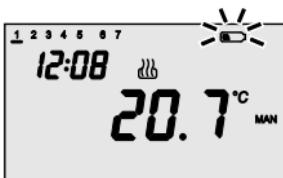
Wenn die Batterien sich kurz vor deren Erschöpfung befinden, beginnt auf dem Display das Symbol zu blinken. Der Betrieb des Chronothermostats wird auf jeden Fall gewährleistet. In diesem Fall müssen die Batterien so bald wie möglich ausgewechselt werden.
