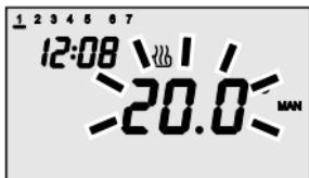
Pour activer le mode de fonctionnement manuel, appuyer sur la touche  $\odot$ , jusqu'à ce que le display affiche le message MAN. Le set point de la température apparaît pendant environ deux secondes.
