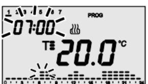
Con las teclas  $\ominus\oplus$  aumente el horario hasta el momento en el que se desea cambiar el perfil propuesto; durante el aumento en el perfil horario parpadea la columna relativa al horario seleccionado. Con las tecla  $\wedge\vee$  seleccione el nuevo set point, que será aplicado hasta el cambio sucesivo presente en el programa.
