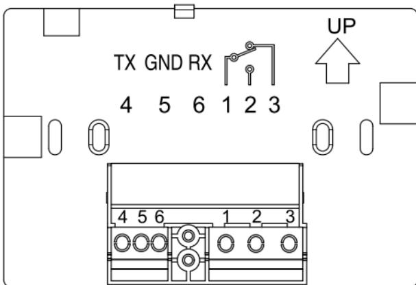
Collegamento per remotizzatore (linea seriale)
