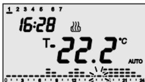
Im **automatischen Betrieb** verwendet der Zustandschronometer ein Programm, das für jeden Tag der Woche differenziert werden kann.
