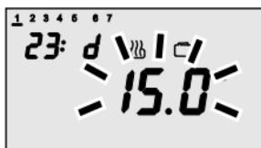
Um die Funktion zu aktivieren betätige man die Taste , auf dem Display erscheint das Symbol während der, in diesem Moment aktive Bezugswert aufblinkt. Stellen Sie mit den Tasten den neuen Bezugswert der Temperatur ein.
