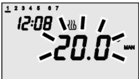
Per attivare la modalità di funzionamento manuale, premere il tasto  $\odot$ , finché sul display appare la scritta MAN. Il set point della temperatura appare per circa due secondi.
