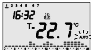
La activación del forzado se indica en la pantalla con la intermitencia del símbolo AUTO
