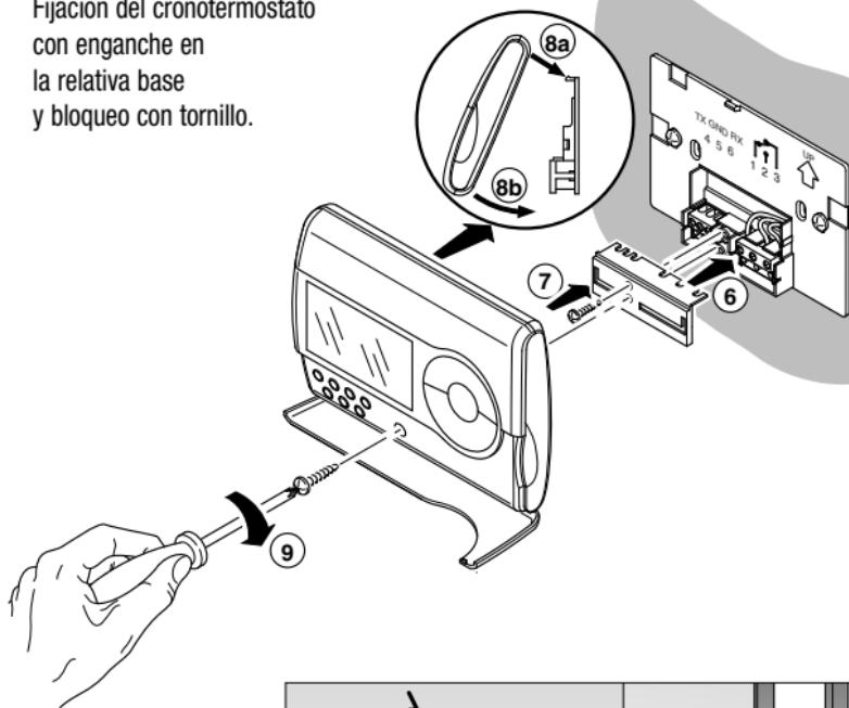
Para la correcta detección de la temperatura del ambiente que se debe controlar es importante que no instale el cronotermostato en cavidades, detrás de las puertas, cerca de las ventanas o fuentes de calor.
