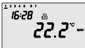
En el **funcionamiento manual** el cronotermostato utiliza permanentemente un set point de temperatura que puede programarse libremente.
