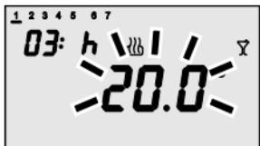
Um die Funktion zu aktivieren betätige man die Taste , auf dem Display erscheint das Symbol während der, in diesem Moment aktive Bezugswert aufblinkt. Stellen Sie mit den Tasten den neuen Bezugswert der Temperatur ein.
