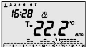
Nel **funzionamento automatico** il cronotermostato utilizza un programma che può essere differenziato per ogni giorno della settimana.
