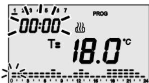
Después de confirmar el día en la pantalla se visualiza el perfil corriente, relativo al día elegido. El horario empieza a parpadear. Seleccione el set-point de temperatura que se desea programar a partir de la hora 00.00, utilizando las teclas  $\wedge\vee$ .
