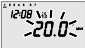
Para activar la modalidad de funcionamiento manual, pulse la tecla , hasta que en la pantalla aparezca la imagen MAN. El set point de la temperatura aparece durante aproximadamente dos segundos.
