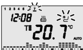
Um die Funktion zu aktivieren, die Taste betätigen. Auf dem Display leuchtet das Symbol und der Balken des Festtages auf.
