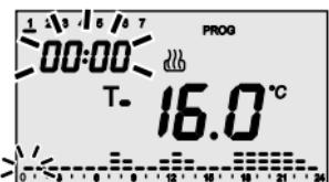
En la pantalla aparecen los símbolos  $T-$ ,  $T=$  o  $T\equiv$  y el valor correspondiente al set point seleccionado. El set point se aplica al perfil horario hasta el primer cambio presente en el programa corriente.
