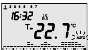
L'activation du forçage est signalée sur l'afficheur par le clignotement du symbole AUTO
